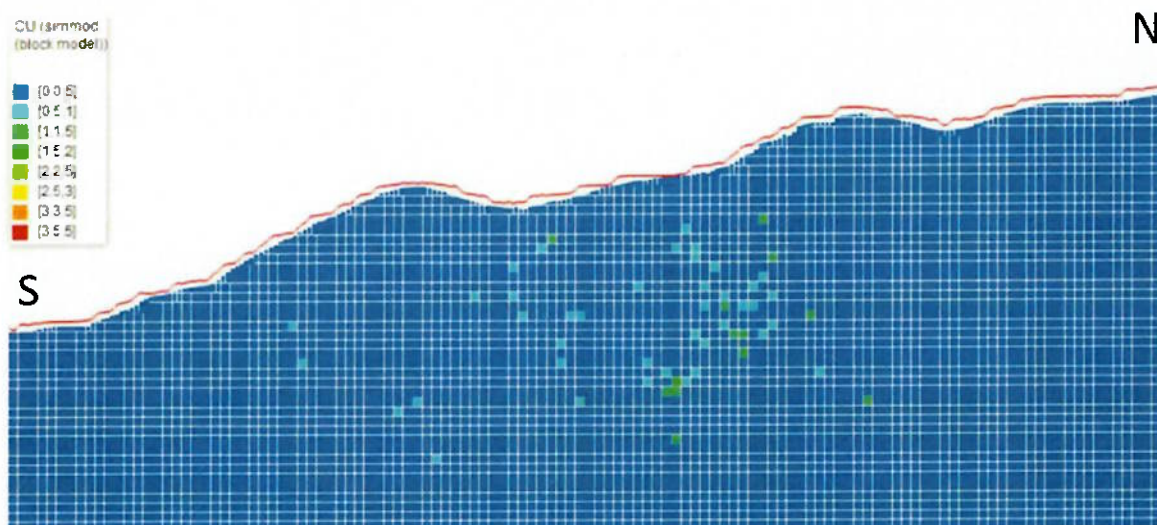
Figura 9: Corte Norte-Sul do modelo de blocos com a topografia inclusa (em vermelho)
